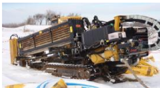
Boreriggen fylder 6m i længden
